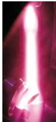
L'utilisation d'une torche à plasma d'arc soufflé à basse pression permet d'obtenir un procédé de revêtement en phase vapeur par "Plasma Spray-Physical Vapor Deposition" (PS PVD), qui est non directionnel, c'est à dire que la croissance du dépôt se fait aussi bien sur des surfaces tangentielles ou cachées.
