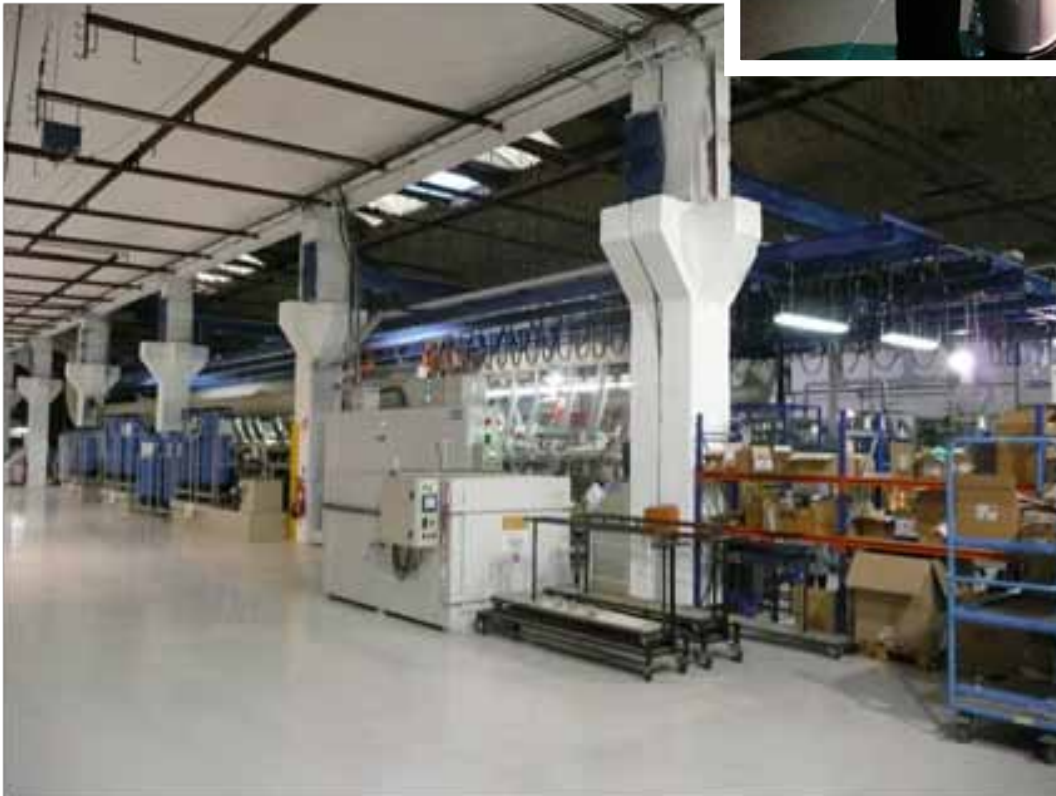
Vue de la ligne automatique de Traitement de Surface
